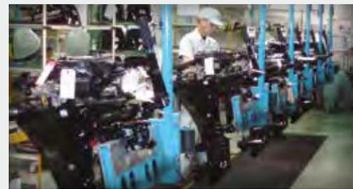
Nach dem Testen montieren die Techniker den Propeller und die Motorhaube. Nach den letzten Qualitätsprüfungen wird der Motor schließlich versandfertig gemacht – so können Sie sich stets auf ein absolut zuverlässiges Produkt verlassen.
