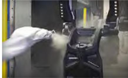
Mercurys Pulverlack enthält Weichmacher, um eine überlegene Flexibilität und haltbare Haftung zu ermöglichen. Die Beschichtung wird thermisch ausgehärtet, was zu einer wesentlich härteren, dickeren und haltbareren Oberfläche führt als bei herkömmlichen Lacken.
