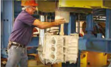
Die Mercury-eigene Lost-Foam-Druckgießerei fertigt Komponenten, die stabiler und leichter sind sowie weniger Befestigungsmittel benötigen und so trotz geringerem Gewicht eine hervorragende Zuverlässigkeit und Stabilität bieten.
