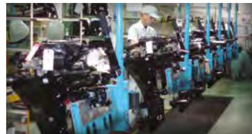
Nach dem Testen montieren die Techniker den Propeller und die Motorhaube. Nach den letzten Qualitätsprüfungen wird der Motor schließlich versandfertig gemacht – so können Sie sich stets auf ein absolut zuverlässiges Produkt verlassen.
