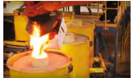
Die Mercury-eigene Lost-Foam-Druckgießerei fertigt aufwendige Gussteile, die weniger Befestigungsmittel benötigen und somit zuverlässiger und leichter sind.
